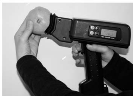
ハンディー型近赤外分光器による、みかん糖度の測定例
